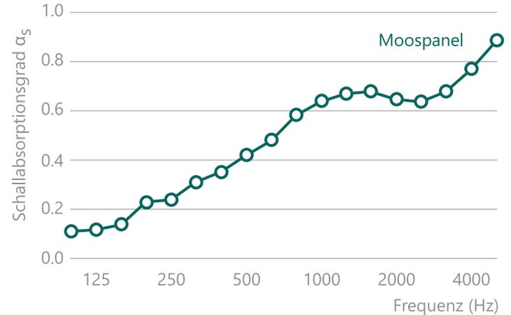
Über den gesamten Frequenzbereich werden im Mittel 45% des Schalls absorbiert. Im hohen Frequenzbereich werden bis zu 90% des Schalls absorbiert.
